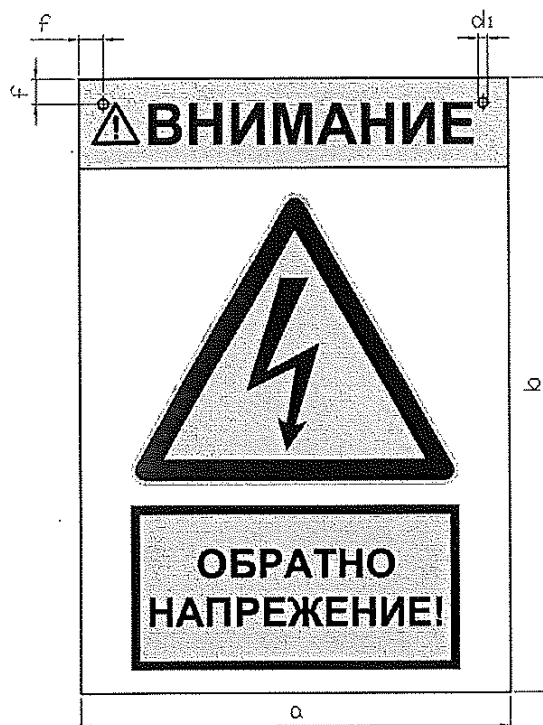
Фиг. 7 Табела “Внимание! Обратное напряжение!”
