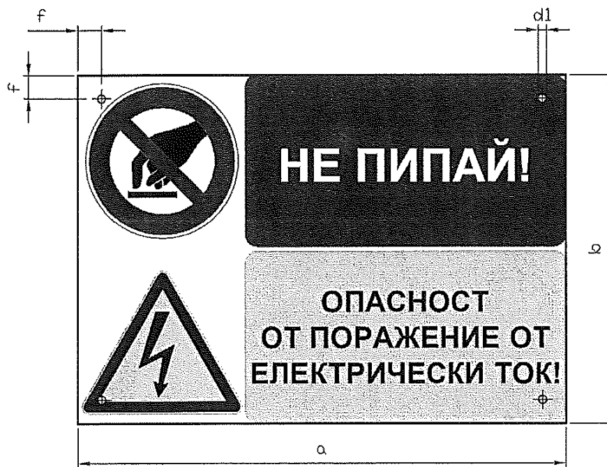
Фиг. 2 Табела „Не пипай! Опасност от поражение от електрически ток!“
